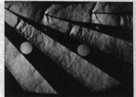
Fig. 10 - Visualisation strioscopique de l'écoulement dans le diffuseur. 8000 t/mn - Calage 12°.
